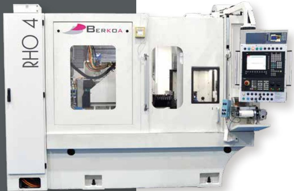
► Rectificadora especial del alojamiento de las zapatas de Bomba Diesel.
