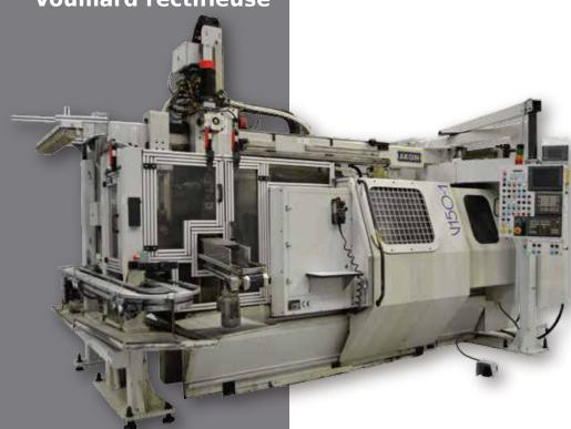
Machine de production pour la rectification simultanée intérieure et extérieure.
