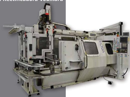
Máquina de producción para el rectificado simultáneo interior y exterior.
